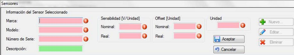
Para dar de alta un nuevo sensor se debe hacer clic en “Nuevo” y luego completar todos los datos que normalmente vienen impresos como certificación del sensor, una vez completados estos campos hacer clic en “Aceptar” y estos datos estarán listos para ser usados como respuesta del sensor elegido al configurar el punto de medición.
