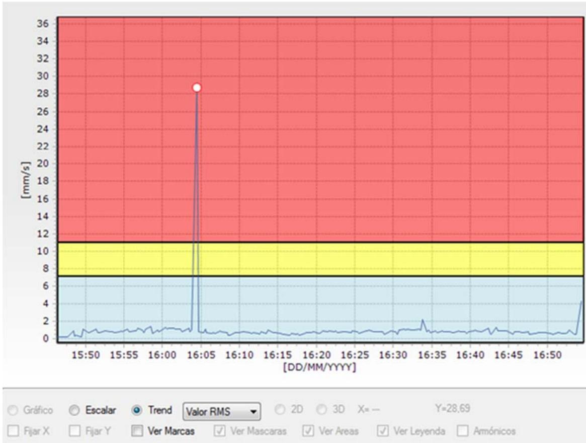
Cuando se consulta una medición espectral, también permite cambiar la vista entre el gráfico de espectro y el trend del valor total de la medición
